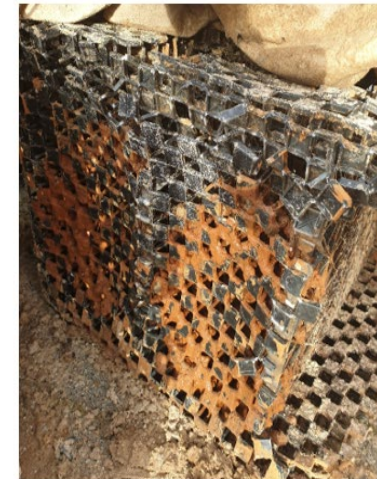
Figuur 2 Krat gevuld met afval, bestaande uit verteerde bladeren, zand en voornamelijk ijzer (te zien aan de bruine kleur).
